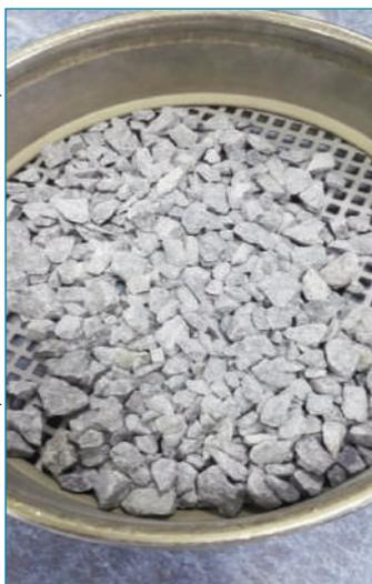
sario lavar el material con algún aditivo peptizante (producto jabonoso) para disminuir a tensión superficial. Si la muestra procede del ensayo de contenido de ligante por incineración (UNE EN 12697-39) se puede realizar el ensayo de tamizado en seco aunque si la muestra que pasa el tamiz 0,063 mm es mayor que el 1 %, se repite el ensayo lavando todo el material.
