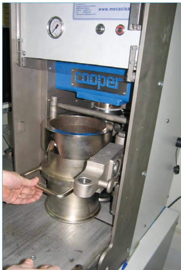
El equipo debe estar correctamente calibrado/verificado, ángulo y fuerza, para asegurar los valores de las alturas, y por lo tanto la densidad, debiendo hacer comprobaciones periódicas (ver anejos de la norma).
