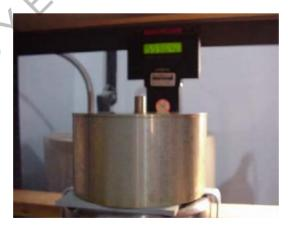
Figura 242 - 10. Pesaje del picnómetro grande
