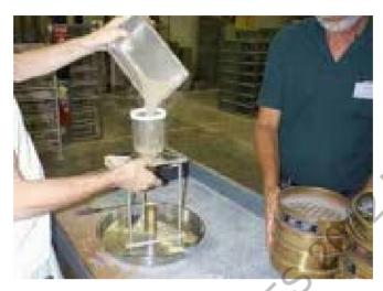
Figura 239 - 3. Vertimiento de la arena dentro del embudo
