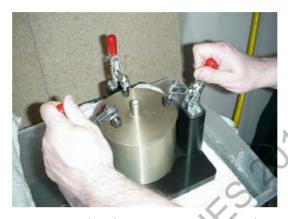
Figura 242 - 15. Se coloca la tapa y se aseguran las abrazaderas
