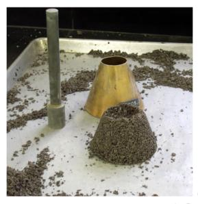
Figura 222 - 3. Agregado con humedad superficial
