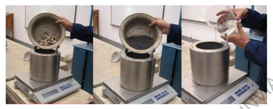
Figura 238 - 3. Colocación de la muestra, la carga abrasiva y el agua dentro del recipiente cilíndrico
