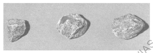
Figura 227 - 4. Partículas fracturadas (bordes redondeados, superficies rugosas)
