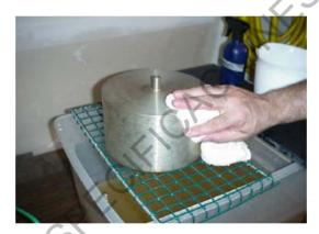
Figura 242 - 9. Secado exterior del picnómetro grande
