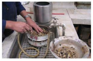
Figura 238 - 4. Lavado de la muestra y las esferas sobre los tamices
