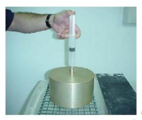
Figura 242 - 8. Uso de la jeringa para completar el llenado del picnómetro grande con agua
